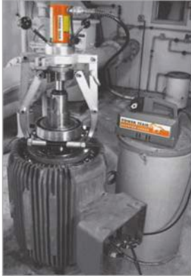
Modelo SGH153CR con un accesorio de extracción de cojinetes para sacar el cojinete del motor de una bomba.
